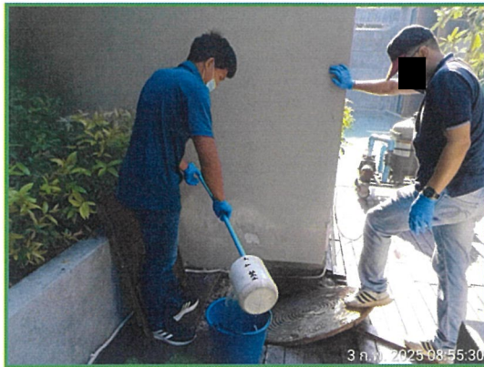
ภาพที่ 1-2 แสดงการเก็บตัวอย่างน้ำเสียก่อนเข้าระบบบำบัดน้ำเสีย (INFLUENT)
