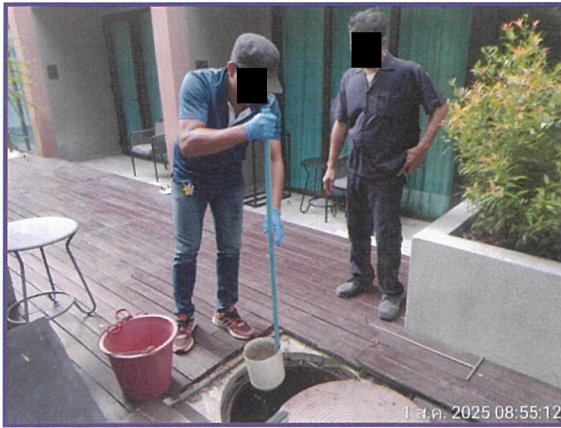
ภาพที่ 1-2 แสดงการเก็บตัวอย่างน้ำผ่านการบำบัด อาคาร 7 (EFFLUENT)
